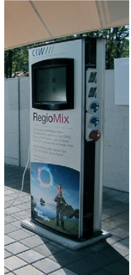
Outdoor Terminal als Stromtankstation für Elektromobile - eines von vielen Inputech-Engineeringprodukten.
